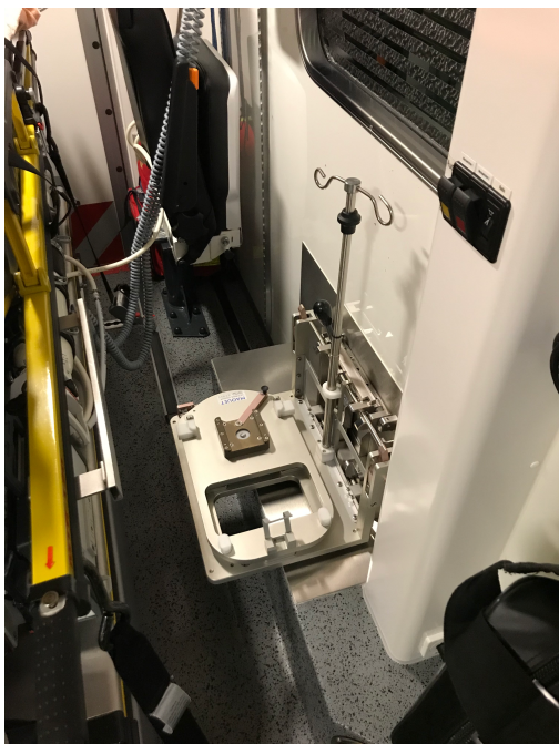
Abb. 11 Fahrzeughalterung ECMO Intensivtransportwagen Schutz und Rettung Bern (Pfander, 2020)
